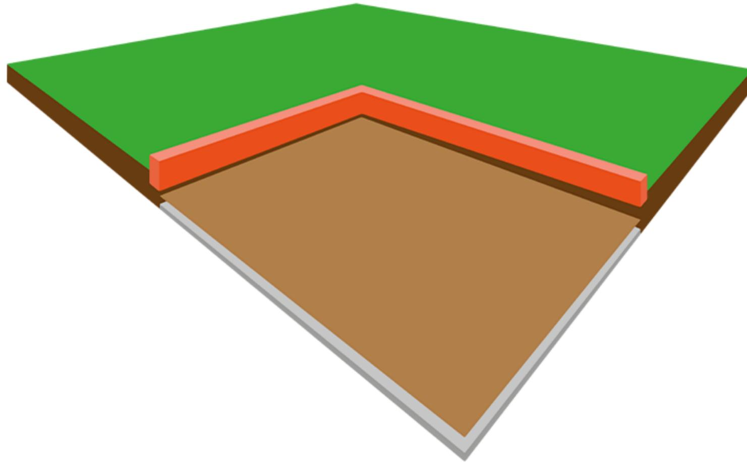
Une fois la nappe de paillage bien installée, disposez les traverses à champ sur le contour de la zone jouable (d'où la nécessité de décaisser plus large que le terrain lui-même).
