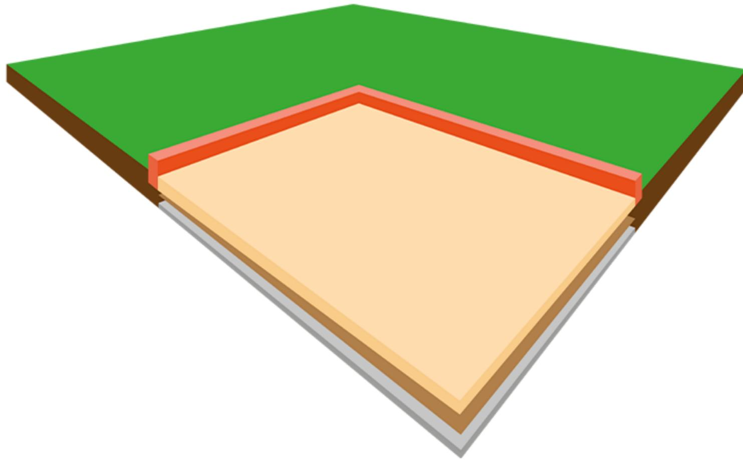
Maintenant disposez une première couche d'environ 2,5 cm de sable sur l'ensemble de la surface et arrosez-le et compactez-le.
