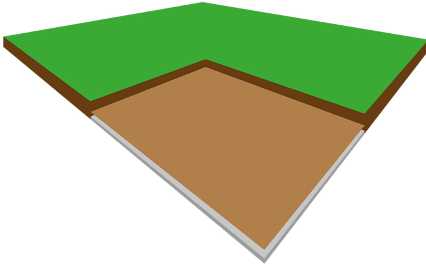
Déposer la nappe de paillage sur les graviers afin de ne pas avoir de mauvaises herbes qui se développent sur votre terrain.
